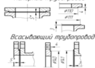
Типы монтажа ответных фланцев Напорный трубопровод
